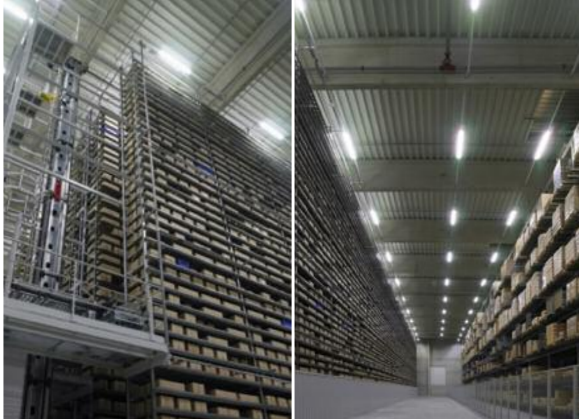
PARTICOLARI DEL SISTEMA AUTOMATICO PER LO STOCCAGGIO DI CARTONI DI DIVERSA DIMENSIONE E DEL SISTEMA AUTOMATICO DI STOCCAGGIO INTENSIVO SERVITO DA TRASLOELEVATORE
