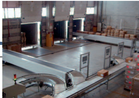
SOPRA, PARTICOLARE DEL SISTEMA AUTOMATICO DI SCARICAMENTO DEI CONTAINER. IN BASSO, VISIONE PARZIALE DEL SISTEMA DI SMISTAMENTO
