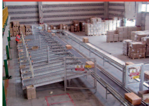
SOPRA, PARTICOLARE DEL SISTEMA AUTOMATICO DI SCARICAMENTO DEI CONTAINER. IN BASSO, VISIONE PARZIALE DEL SISTEMA DI SMISTAMENTO
