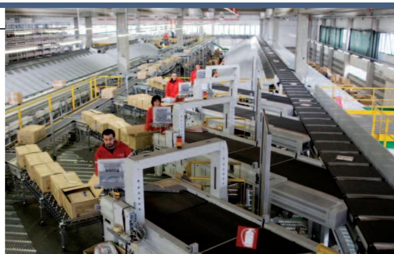
IL SORTING CON TECNOLOGIA CROSS-BELT
