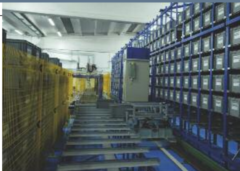
NAVETTA PER LA MOVIMENTAZIONE DELLE CASSETTE DA/VERSO IL MAGAZZINO AUTOMATIZZATO. IN BASSO, IL ROBOT CARTESIANO PER IL PRELIEVO DA CASSETTE
