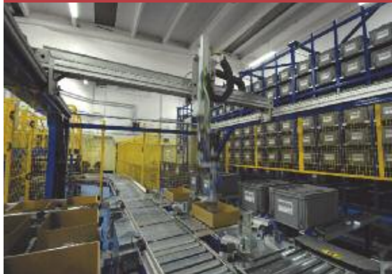
NAVETTA PER LA MOVIMENTAZIONE DELLE CASSETTE DA/VERSO IL MAGAZZINO AUTOMATIZZATO. IN BASSO, IL ROBOT CARTESIANO PER IL PRELIEVO DA CASSETTE
