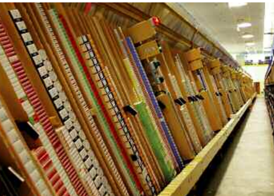
PARTICOLARI DEL SISTEMA AUTOMATICO (DISPENSER "A FRAME")
