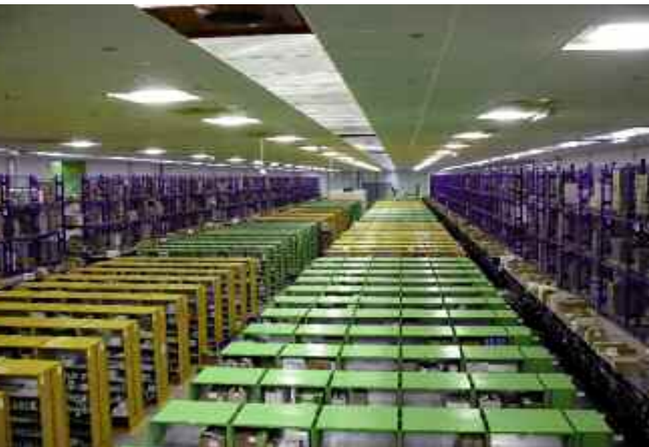
L'AREA PICK-TO-BOX CON LOGICA DI PRELIEVO DI TIPO "ZONE PICKING" È SERVITA DA RULLIERE MOTORIZZATE
