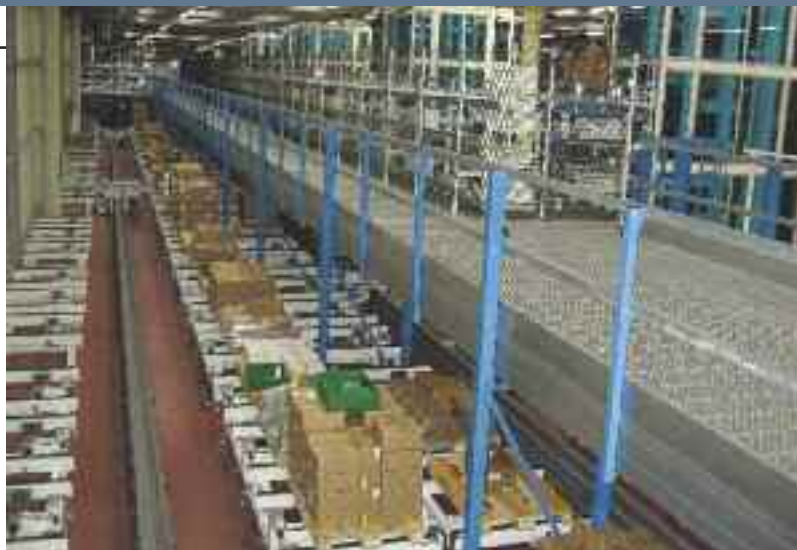
MAGAZZINO PALLET (A SINISTRA) E SISTEMA DI MOVIMENTAZIONE IN INGRESSO/USCITA CON BUFFER PER UDC
