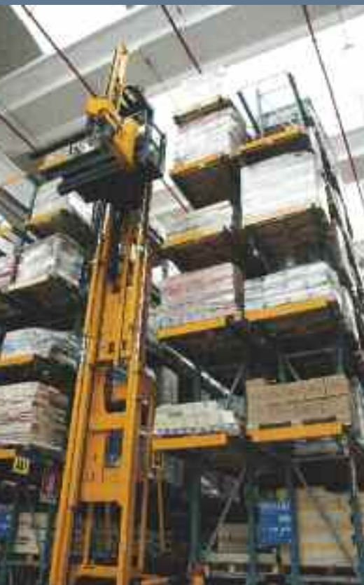
CARRELLO TRILATERALE PER I PRODOTTI "A" E "B" DEL DISTRIBUTORE. IN BASSO, PARTICOLARE DEL SISTEMA DI SORTING
