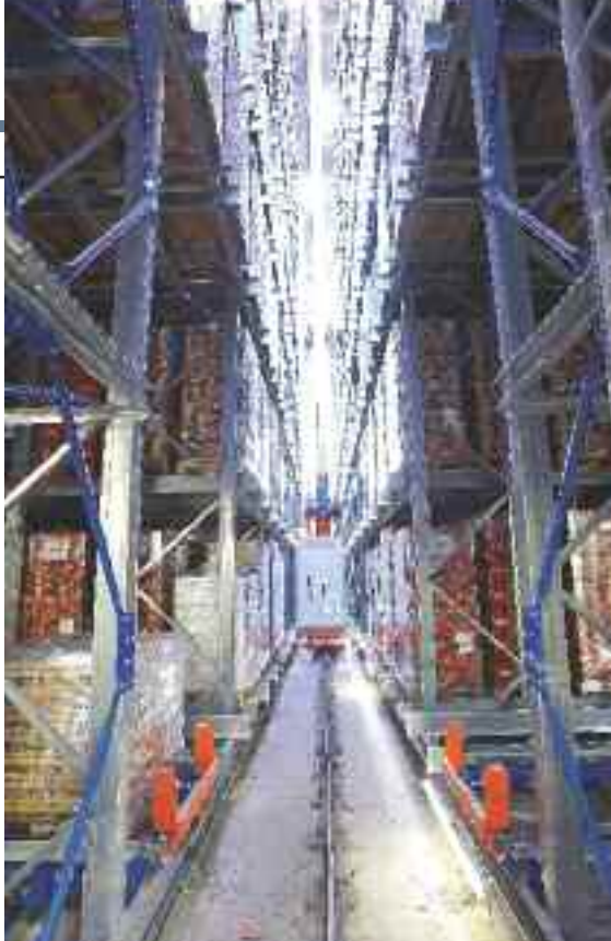
A SINISTRA, PARTICOLARI DELL'IMPIANTO AUTOMATIZZATO SERVITO DA TRASLOELEVATORE E DISPOSITIVO A SATELLITE; A DESTRA, ALCUNI PARTICOLARI DEL SITO DI DRINK INTERNATIONAL
