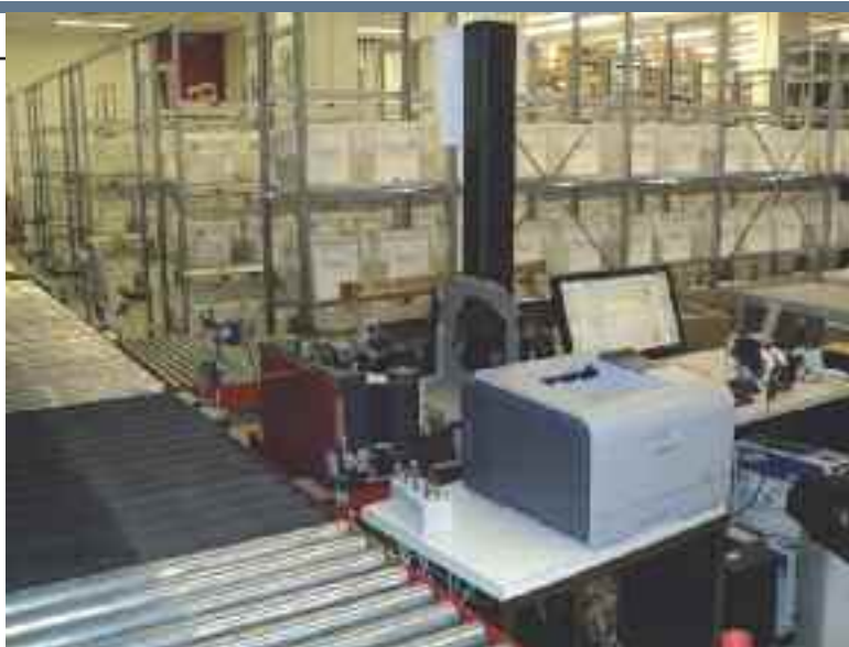
SISTEMA PUT-TO-LIGHT PER LO SMISTAMENTO A VALLE DELLE ATTIVITÀ DI PRELIEVO
