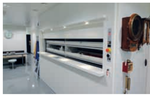
Carosello verticale automatico per la gestione dei pezzi di ricambio
