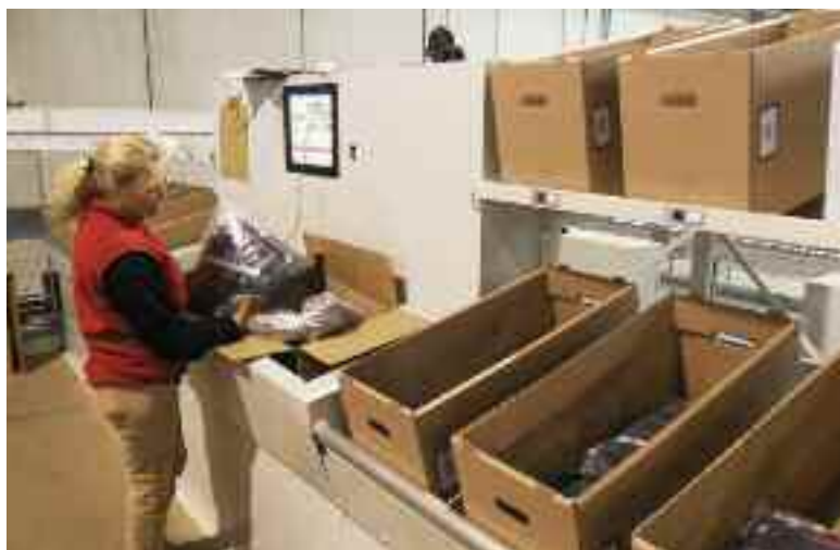
Sistema di smistamento con tecnologia put-to-light
