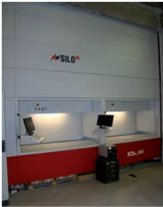
Particolare della baia di prelievo del magazzino verticale automatico
