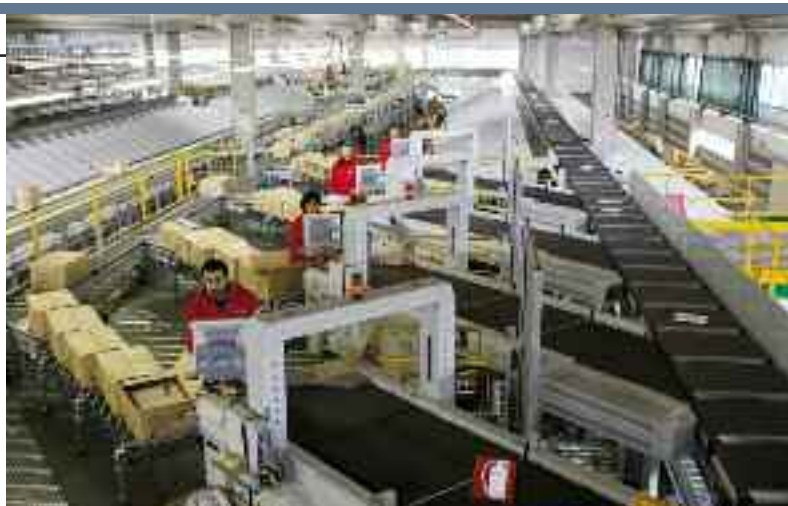
IL SORTING CON TECNOLOGIA CROSS-BELT
