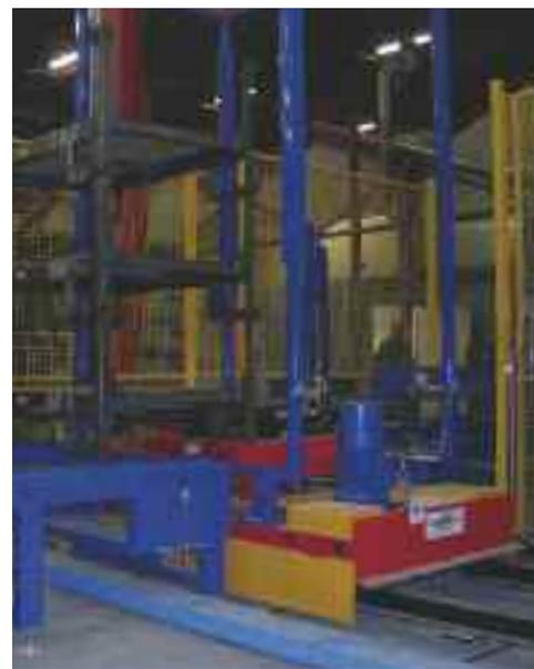
nali vengono, come detto sopra, deimpilati e reimpilati in funzione della macchina di provenienza da un robot ad assi cartesiani di impilamento pianali. La movimentazione delle pile di pianali in ingresso/uscita dal forno è stata realizzata mediante navette con controllo di posizione realizzato con encoder assoluto Profibus-DP.
