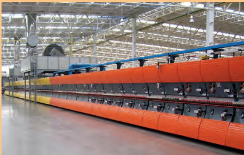
*Sacmi: forno a rulli monostrato per la cottura di piastrelle in ceramica*
