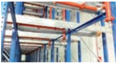
Impianto satellitare Drive in (realizzato da Sacma) con dettaglio delle testine a copertura di ogni posto pallet
