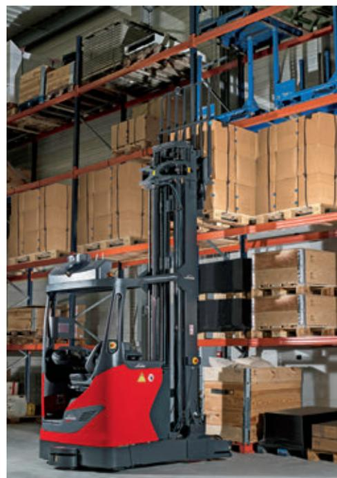
Il carrello retrattile automatizzato R-MATIC, della linea Linde Robotics, al lavoro in magazzino
