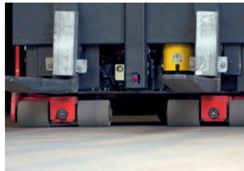
diagonalmente dall'alto verso il basso in grado di rilevare anche eventuali ostacoli che non poggiano a terra. Sul lato posteriore sono presenti altri due laser, uno per monitorare l'attività delle forche e la presenza del carico e uno parallelo al piano del terreno per identificare eventuali ostacoli. In caso di rilevazioni il mezzo prima rallenta, poi si blocca in prossimità dell'ostacolo.
